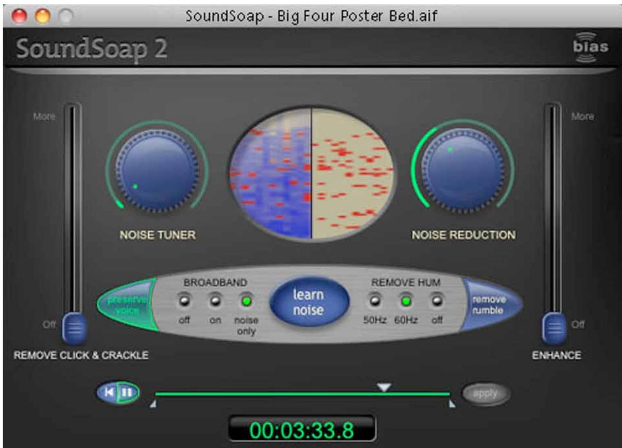
上図はSound Soapでのノイズ除去作業。楕円ウィンドウの左半分の中の赤いブロックがノイズを現し、右半分がノイズのみを表示しています。
