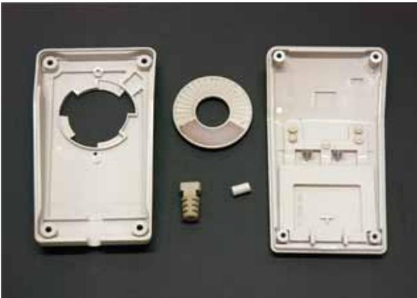
左から下部ケース、マウスボールカバー、コードブッシュ、マウスドライブの支柱(他のサイトでは「クリック高の調節用に使用」とあったので保存。上部ケース(クリックボタン)。
