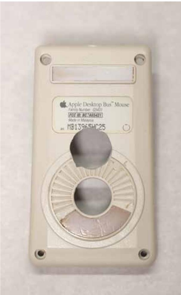
本体はプラスチックなので柔らかく、円切りカッターで比較的簡単に切れる。レンズ径より小さめ(16mm)で窄孔し、シャーシリーマーで調整しながら、かっちり収まる寸法もで削った。
