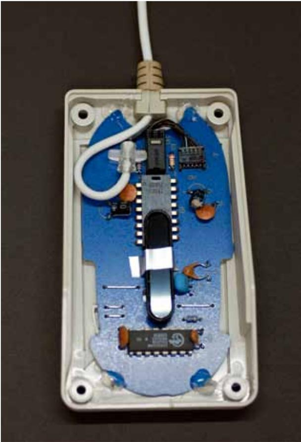
遮光カバーを付けUSBケーブルを接続。
