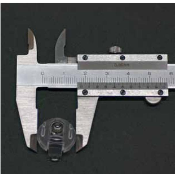
レンズ孔を孔けるため採寸。誤差が怖いのでノギスで正確に計る。18mmである。
