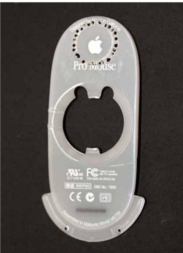
Pro Mouseの残骸からケースカバーにApple Logoがあるのを発見。これを戴くことに。こちらは硬質塩ビで円切りカッターの刃がたたない。止むなくドリルで切り取り円周に沿って穴を孔ける。ドリル孔をノミで切り裂く。楕円になってしまった。おまけに寸法が小さくなってしまった。ドリルの刃の径を失念し、仕上がり罫の上に穴を孔けてしまったのが原因、これも裏側で見えない…(泣)。
