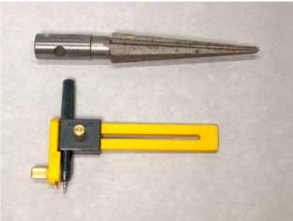
レンズ孔の穴孔けに使用した工具。
