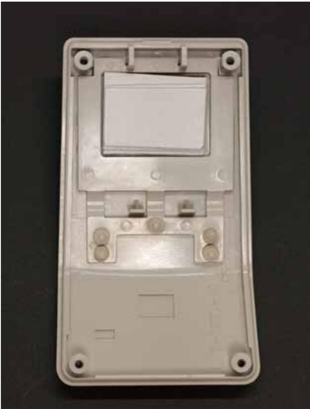
他のサイトでは角マウスのボールユニット支持柱を流用と書かれていたが、これがとても緻密で面倒。しからば…と厚紙を数層に両面テープで貼り付けた。経年劣化で感度が鈍ってければ張り替えればよい。
